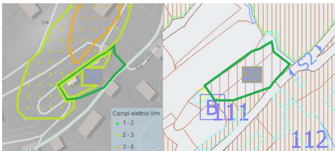
Previsione numero 20, sovrapposizione con la mappatura dei campi elettrici (a sinistra) e planimetria di piano (destra). La densità di campo rilevata è inferiore a 3 V/m. Fonte: ARPA Piemonte.
